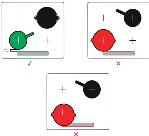
Vyhnite sa kladeniu zahriatych nádob (napr. hrncov, panvíc) na ovládaci panel a zabezpečte, aby sa počas varenia okraj nádoby nedotýkal ovládacieho panela – hrozí poškodenie ovládacieho panela a celej varnej dosky!
