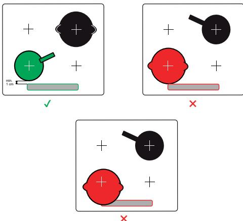
Vyvarujte se pokládání zahřátých nádob (např. hrnců, páneví) na ovládací panel a zajistěte, aby se během vaření okraj nádoby nedotýkal ovládacího panelu – hrozí poškození ovládacího panelu a celé varné desky!
