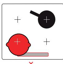
Vyhnite sa kladieniu zahriatých nádob (napr. hrncov, panvíc) na ovládaci panel a zabezpečte, aby sa počas varenia okraj nádoby nedotýkal ovládacieho panela – hrozí poškodenie ovládacieho panela a celej varnej dosky!
